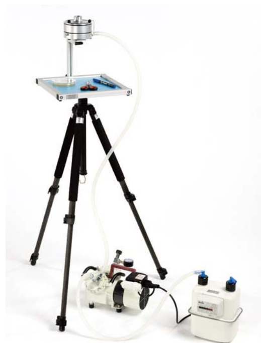
Mikrobiologische Luftprobenahme mit der Pumpe MP2/39 Das Bild zeigt optionales Zubehör
