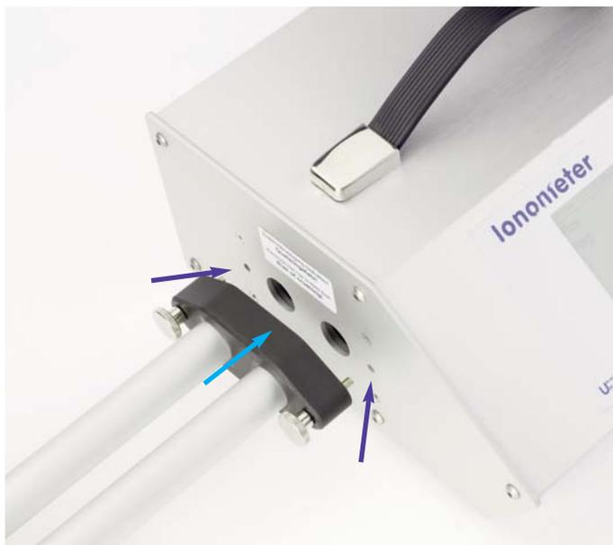
Bild 36 Montage der Ansaugverlegung
