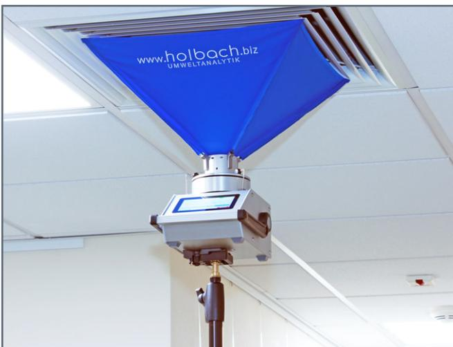
Die Anwendung ist einfach und sicher: Probenahmegerät auf kleinster Stativhöhe vorbereiten und die Probenahme mit Startverzögerung starten. Anschließend einfach während der Startverzögerungszeit das Gerät auf dem **Stativ366** unter dem Deckenauslass positionieren.
