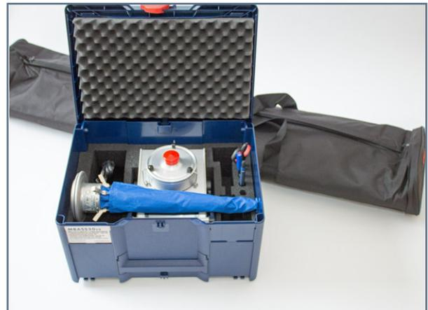
Das **Stativ366** in der gepolsterten Tragetasche und der Koffer mit dem Probenahmegerät und dem Lufteinlauftrichter **LET40** und den Sammelmedien. Mehr ist für die Probenahme nicht zu transportieren.
