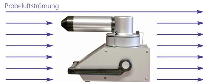
Probenahme in externer Probeluftströmung mit Queradapter und Einlaufdüse
