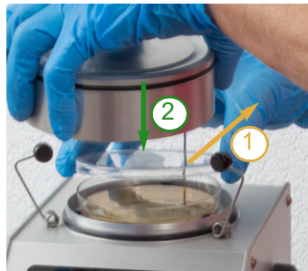
Bild 49 Deckel entnehmen, Sammelkopf aufsetzen
