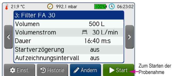
Bild 15 Starten der Probenahme
