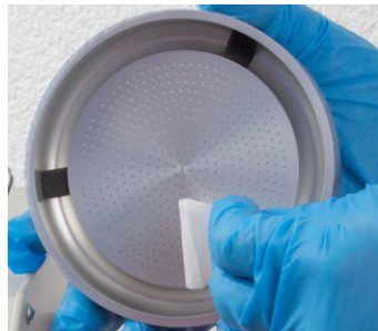
Bild 45 Düsenplatte unten reinigen
