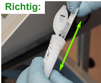
Bild 61 Position des Objektträgers bei Entnahme oder Einschoben
