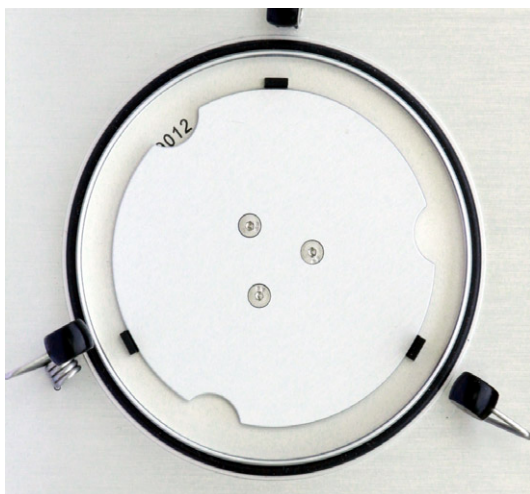
Bild 6 Medienzentrierung eng, Einstellscheibe auf 12
