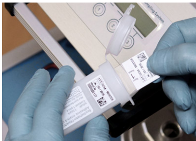
Bild 60 Entnahme des adhäsiv beschichteten Objektträgers
