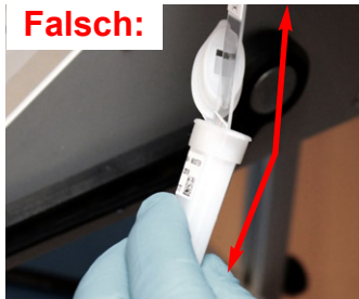
Bild 61 Position des Objektträgers bei Entnahme oder Einschoben
