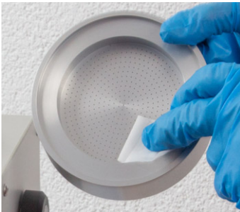
Bild 44 Düsenplatte oben reinigen
