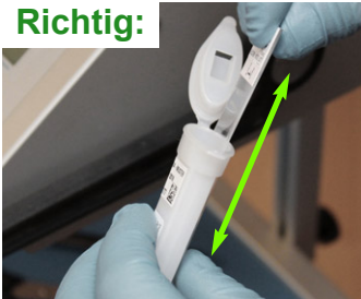
Bild 61 Position des Objektträgers bei Entnahme oder Einschieben
