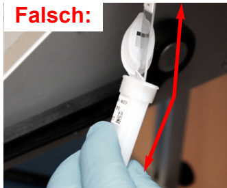
Bild 61 Position des Objektträgers bei Entnahme oder Einschieben
