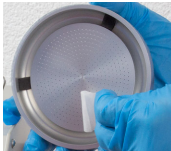
Bild 45 Düsenplatte unten reinigen
