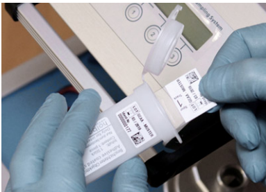
Bild 60 Entnahme des adhäsiv beschichteten Objektträgers
