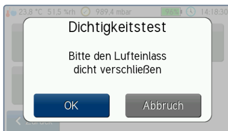
Bild 65 Dichtigkeitstest vor dem Start
