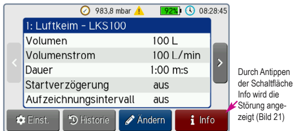
Bild 22 Eine Störung liegt an, eine Probenahme ist nicht möglich
