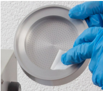
Bild 44 Düsenplatte oben reinigen
