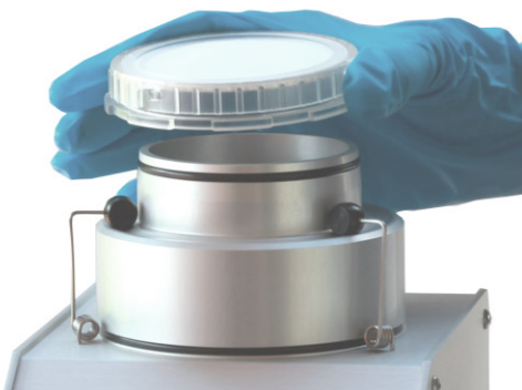
Bild 57 Aufsetzen eines Gelatinefilters in einer Einweeinheit
