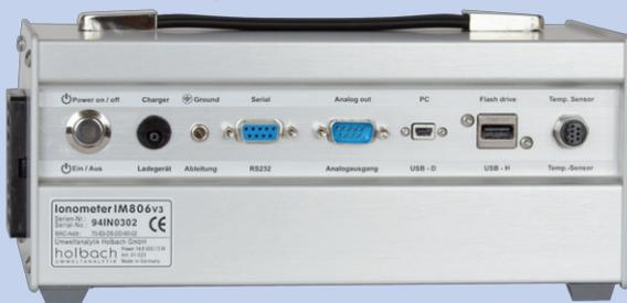
Die Anschlussbuchsen sind mit Ausnahme der Netzwerkbuchse versenkt in der Rückwand angebracht.
