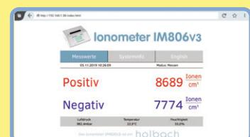
Im Ionometer **IM806v3** sind ein Web- und ein FTP-Server integriert. Die Messwerte und die Konfiguration können netzweit angezeigt werden.
