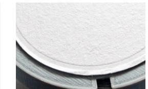
Der Andruck der Dichtlippe auf der Unterseite des Verschlussrings ist auf dem Filter sichtbar. Filter entnehmen.
