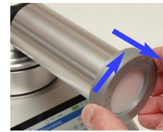
Filterhalter im Uhrzeigersinn drehend aus dem Aufnahmehohr des Queradapters ziehen.
