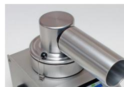
Queradapter mit PU-Schaumzylinder bestücken.
