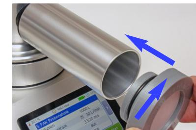
Filterhalter in das Aufnahmehohr des Queradapters einsetzen und im Uhrzeigersinn drehend bis zum Anschlag in das Aufnahmehohr schieben.
