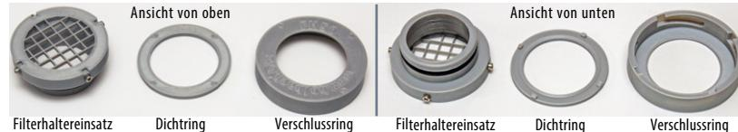
Der Filterhalter FH50 besteht aus dem Filterhaltereinsatz, dem Dichtring und dem Verschlussring. Der Dichtring dichtet den Filter seitlich ab und schützt den Filter beim Verschließen mit dem Verschlussring vor mechanischer Reibung.
