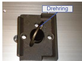
Klappen Sie den Drehring auf der Unterseite der Platte aus und schrauben Sie die Platte an das Gerät. Klappen Sie den Drehring nach dem Anschrauben wieder ein.
