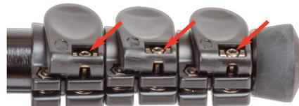
Lässt sich der Hebel nur schwer betätigen, dann sind die Schrauben zu fest zuge dreht.
