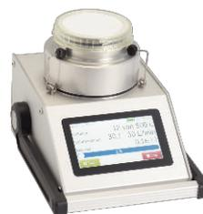
Luft auf sterile 80 mm Gelatinefilter in Einweg-Einheiten filtrieren mit dem Filteradapter **FA 30**
