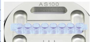
Die Aufnahme für das Sammelmedium Mikrotiterstreifen (hier blau eingefärbt) kann auch den Objektträger für den Partikelsammelkopf **PS 30** aufnehmen.
