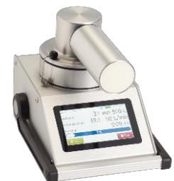
PU Schaumzylinder beladen für chemische Luftprobenahmen mit dem Queradapter
